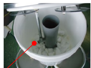
P18 型分離槽内ひも状吸油材 ■吸油材が全体に油を吸着し汚れてきたら交換。
