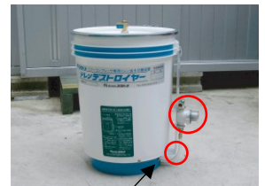
■ 処理水の白濁または油の流出を確認して交換
