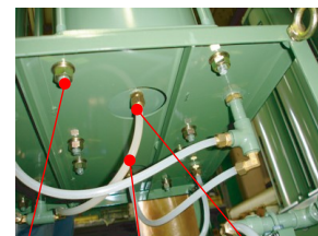
⑤槽取付ナット ③下部チューブ ④ナット
